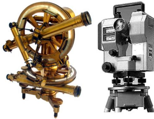
Figura 2.1: Teodolito do século XIX e teodolito eletrônico
